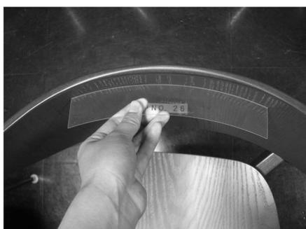
図-1 カーブ定規によるカーブの計測
