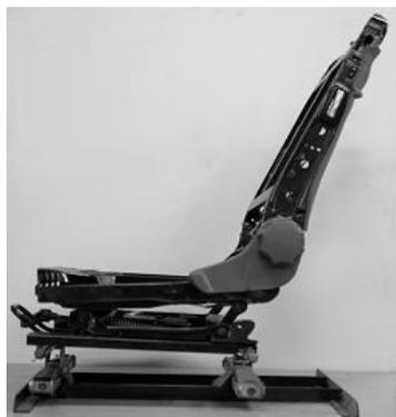
図-4 座面高、座面傾斜角、背開き角度計測装置
