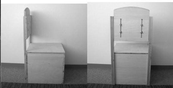
図-2.1 背笠木高、座面高計測器具 図 2.2
