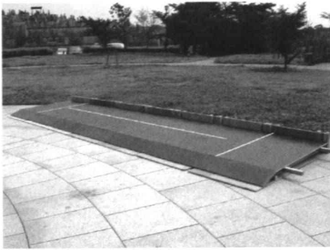
写真3.1 横断勾配実験装置 (長さ6.5m×幅1.5m、車いす移動区間4.5m)
