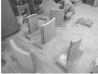
写真7. 脱型完了状況
