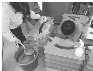
写真 5. グラウト流し込み状況
