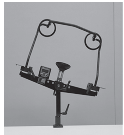
図1 改良型顎台とデジタル角度計
